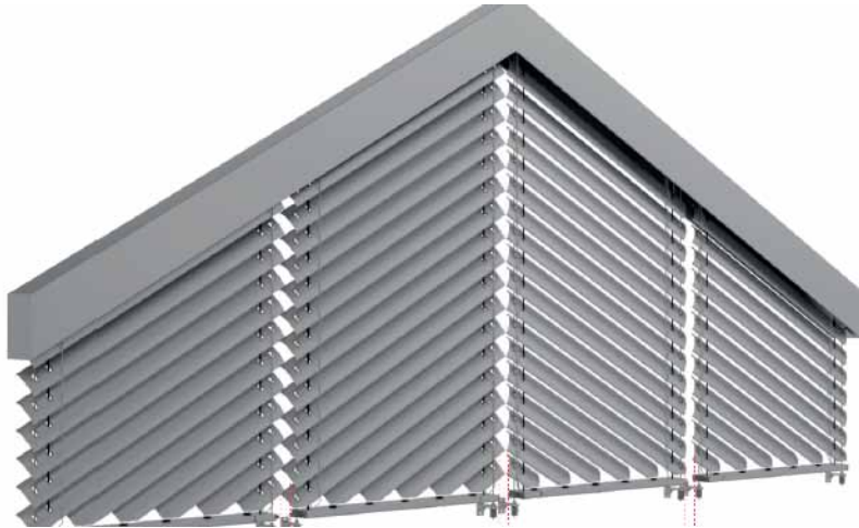
Minimální mezera 30mm Minimální mezera 50mm Minimální mezera 30mm
